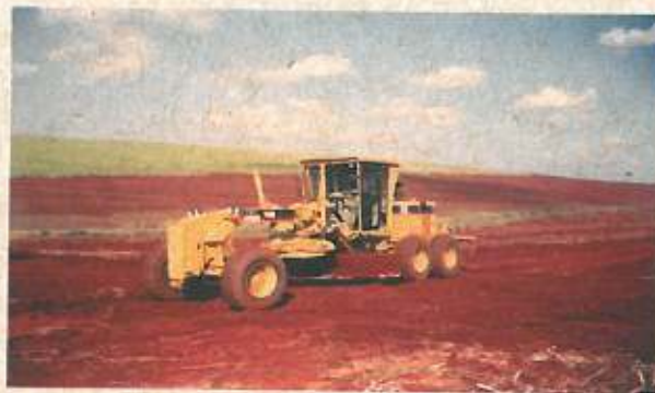
Nivelación de parcelas con Motoniveladora
