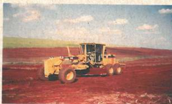
Nivelación de parcelas con Motoniveladora
